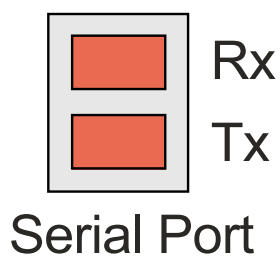
Rys. 11 Wskaźnik LED odbioru i wysłania danych przez port komunikacyjny
