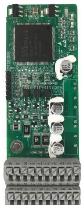
24V incremental PG card AS28ENC0004
