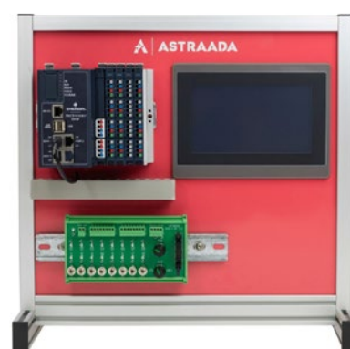
• Stanowisko edukacyjne ze sterownikiem Emerson PACSystems RSTi-EP CPE205
