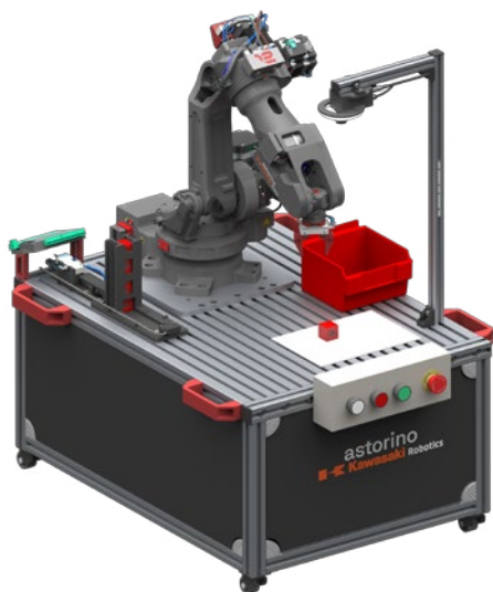
Rys. 1. Stacja PRO wraz z robotem Kawasaki Robotics Astorino oraz dodatkowym osprzętem
