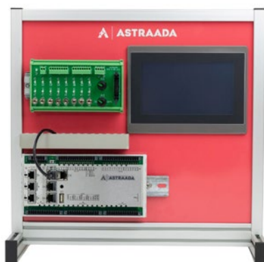
• Stanowisko edukacyjne ze sterownikiem Astraada One ECC2220
