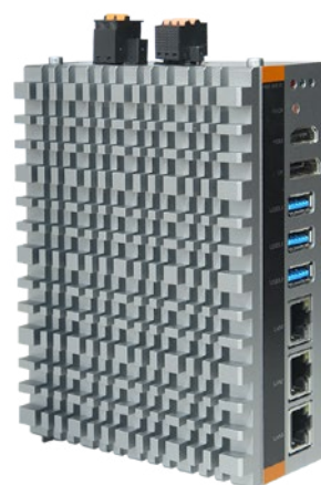
❖ Komputer przemysłowy Astraada o wymiarach 138 x 102 x 45 mm. Źródło: ASTOR
