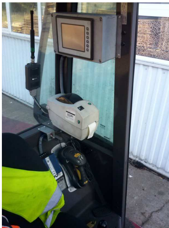
Rys.2. System rejestracji produkcji w wózku widłowym w zakładzie Swedwood
