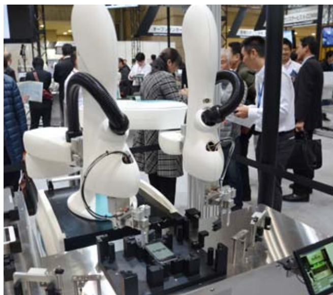
◊ Dwuramienny robot Kawasaki duAro na stanowisku testowania urządzeń elektronicznych (telefon, tablet, laptop)
