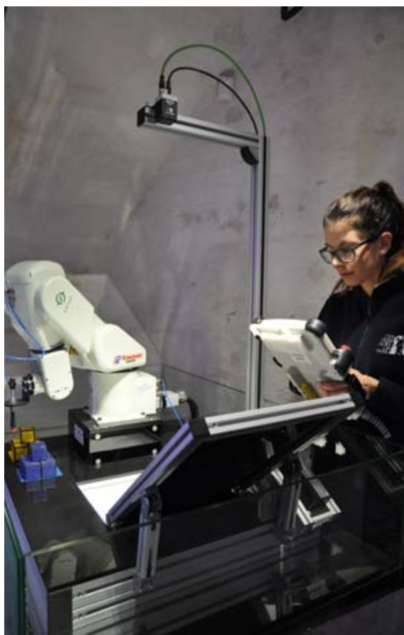
• Robot Kawasaki RS003N z systemem wizyjnym Sensopart
