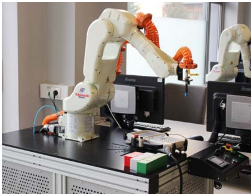
• Komunikacja pomiędzy robotem Kawasaki RS005L a sterownikiem XL4e firmy Horner APG zrealizowana przy pomocy protokołu Software Ethernet/IP
