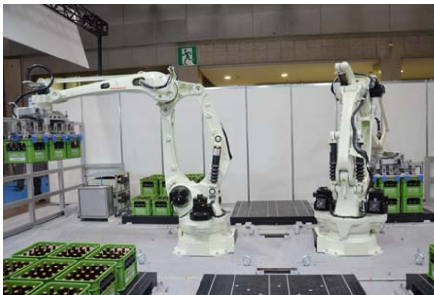
◉ Wyścig paletyzatorów Kawasaki (robot CP300L oraz CP500L podczas paletyzacji skrzynek).
