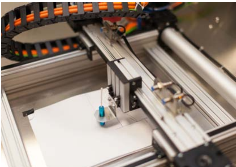
• Stanowisko realizujące funkcję plotera z dwiema osiami ruchu
