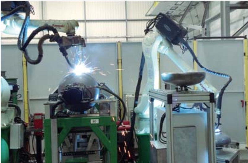
• Zrobotyzowane spawanie Kawasaki w celi spawalniczej
