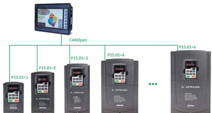
Komunikacja falowników Astraada DRV-27 z systemem sterowania
