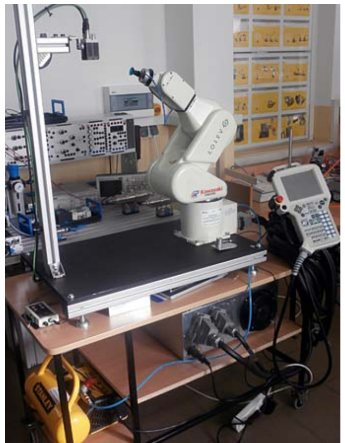
Robot Kawasaki z systemem wizyjnym Visor V10
