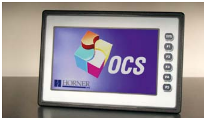
Sterownik z panelem operatorskim XL7e od Horner APG
