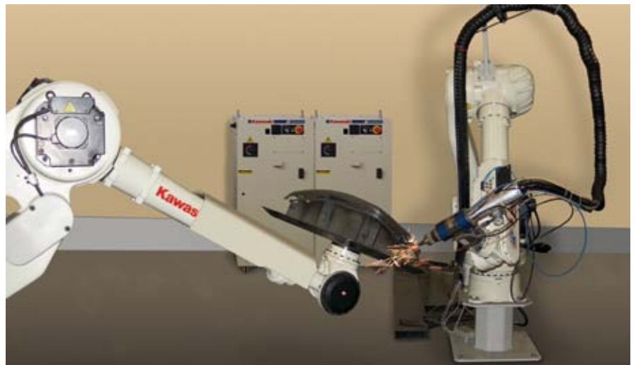
Proces cięcia laserem realizowany przez dwa roboty Kawasaki
