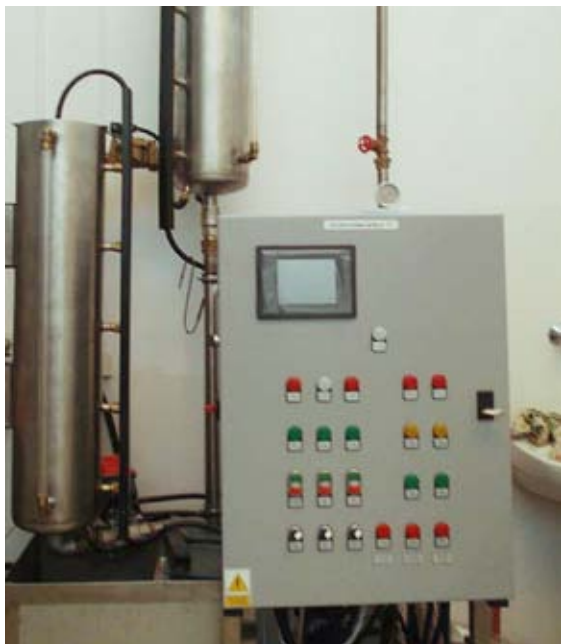
Sterowanie przepływem płynów między zbiornikami
