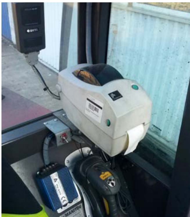
Rys.2. System rejestracji produkcji w wózku widłowym w zakładzie Swedwood
