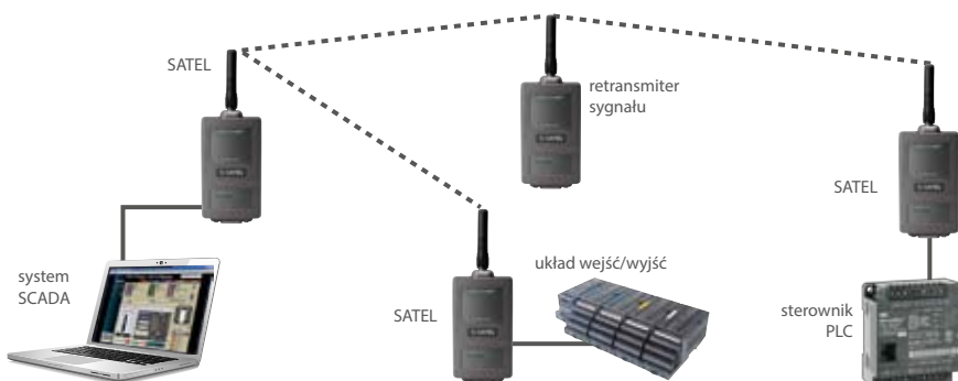
Przykład systemu bezprzewodowego, który łączy oprogramowanie wizualizacyjne z oddalonymi urządzeniami sterującymi
