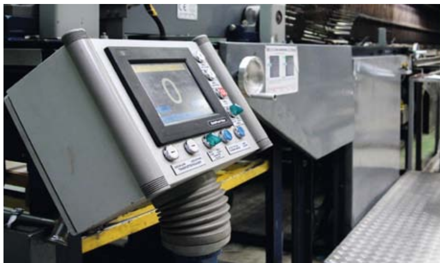
Stanowisko operatora tandemowej linii lakierniczej
