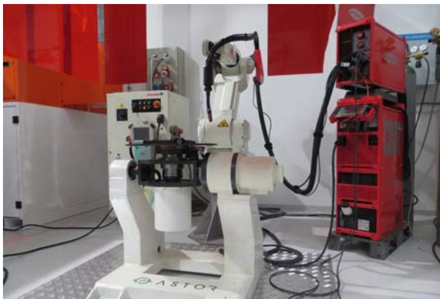
Zrobotyzowane spawanie z robotem Kawasaki FA006E z pozycjonerem dwuosiowym w technologii CMT
