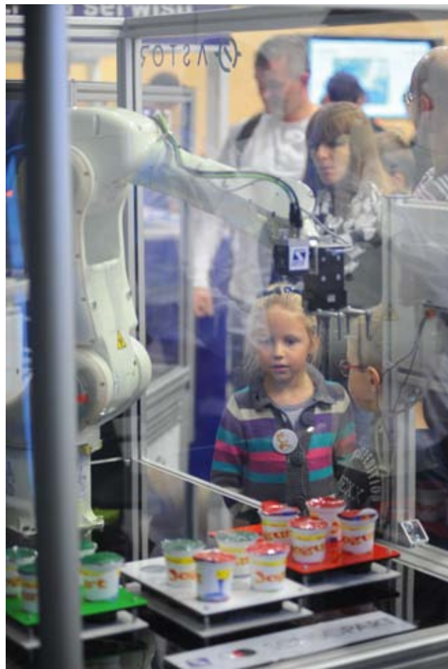
Robot Kawasaki z systemem wizyjnym SensoPart w aplikacji kompletowania zestawów jogurtów.
