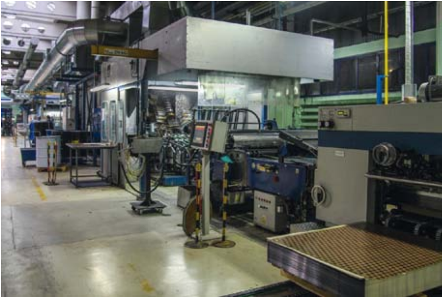
Tandemowa linia lakiernicza w firmie CAN-PACK S.A.
