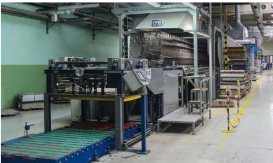
Tandemowa linia lakiernicza w firmie CAN-PACK S.A.
