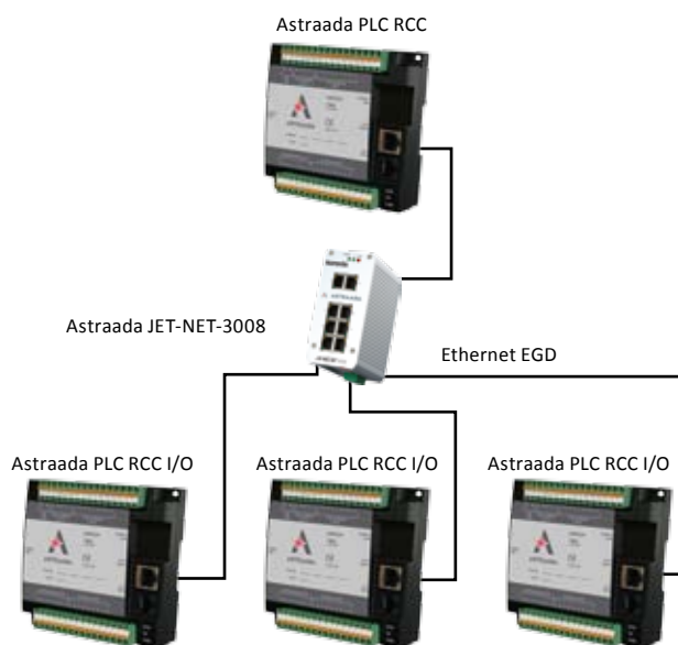
Rozbudowa systemu sterowania przy pomocy urządzeń RCC jako układu I/O na sieci Ethernet
