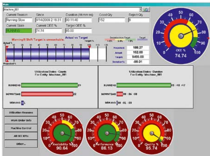
Wizualizacja w czasie rzeczywistym wskaźnika OEE wyliczanego automatycznie przez system Wonderware MES.
