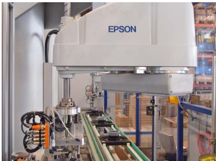
Robot Epson SCARA G6 pracujący na linii montażowej
