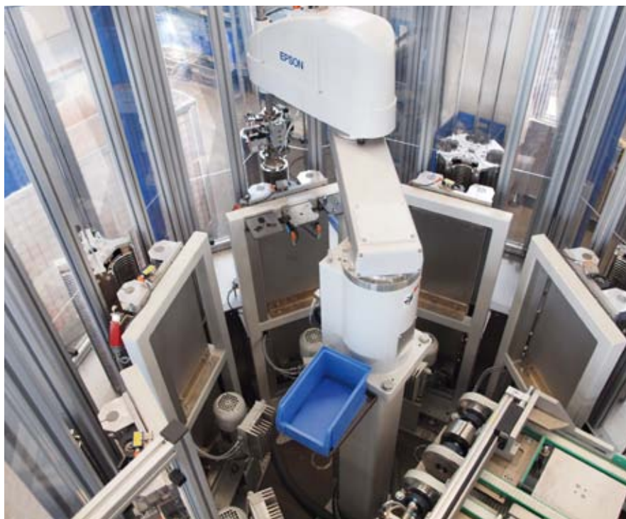
Robot Epson SCARA G3 wyposażony w głowice do montażu
