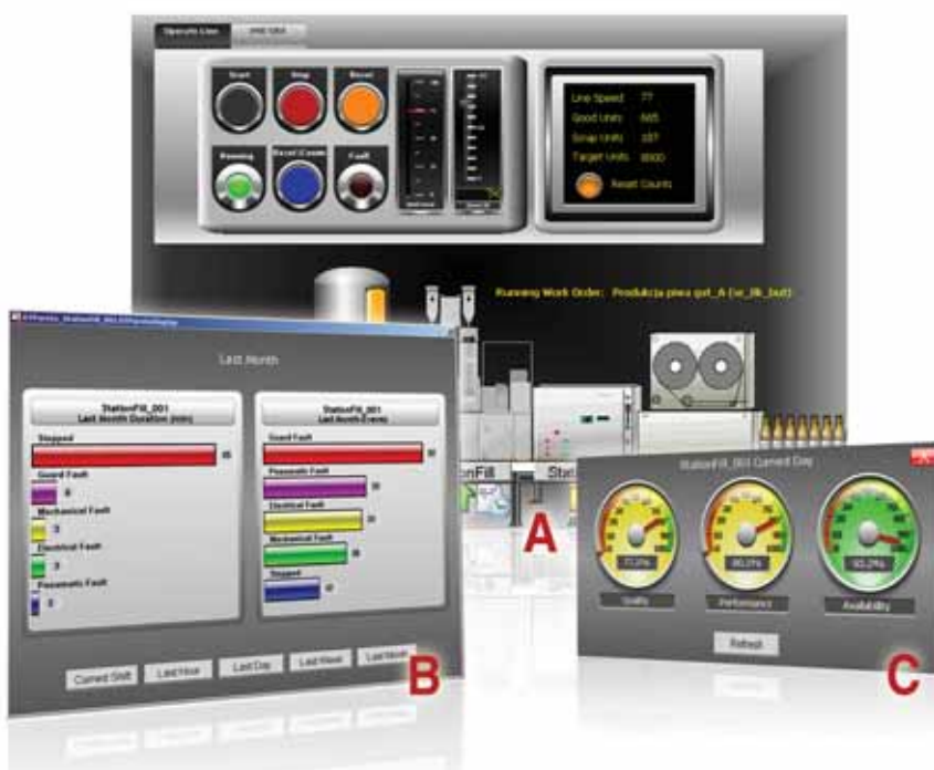
Rys. 2. Przykładowe okno w systemie monitoringu wydajności (A), oraz symbole Archestra Graphics z informacją o ilości i czasie przestoju (B), a także składnikami Wynikowej Efektywności Maszyny (OEE).
