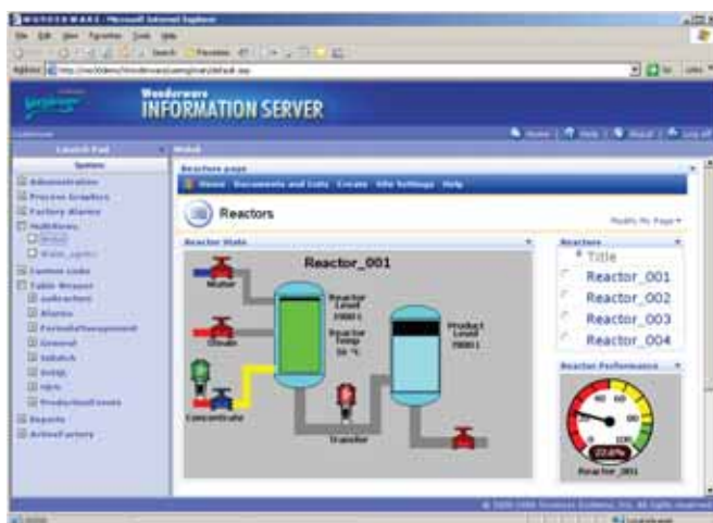
Okno widoku złożonego z fragmentu aplikacji wizualizacyjnej, panelu wyboru reaktora oraz miernika efektywnej wydajności pracy wybranego systemu
