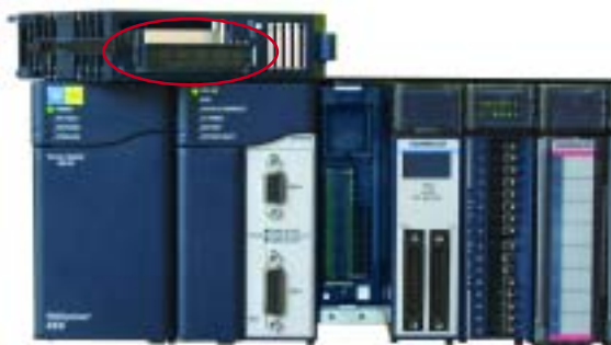
Rys. 2. Moduł z gniazdem Compact PCI
