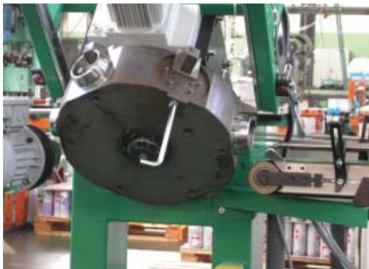
Rys. 2 Urządzenie znakujące w trakcie montażu końcowego
