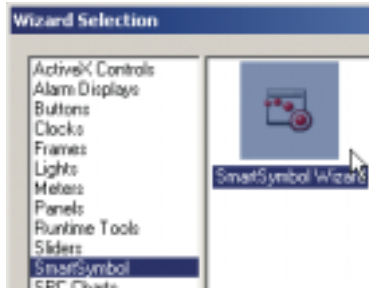
Rys. 4 Wstawianie obiektu SmartSymbol do okna aplikacji InTouch
