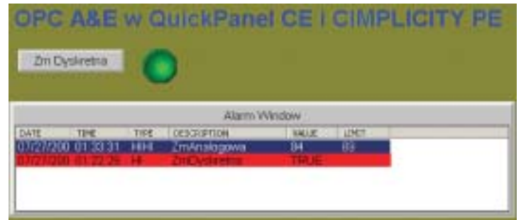
Rys. 6 Przykładowa aplikacja wyświetlająca alarmy, uruchomiona na panelu Quickpanel CE
