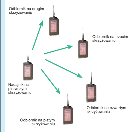
Rys. 1. Poglądowy schemat systemu koordynacji sygnalizacji świetlnej
