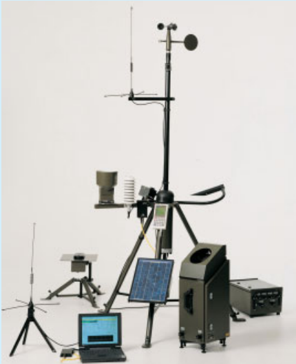
Rys. 1. Radiomodem Sateline-3AS w dodatkowej obudowie zainstalowany na stacji MAW301
