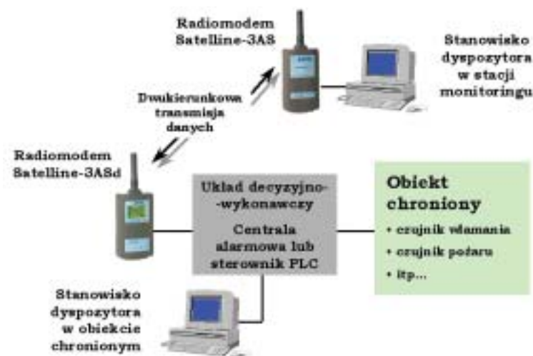
Przykładowy system sygnalizacji i rejestracji zagrożeń oparty na radiomodemach Sateline-3AS(d) EPIC.
