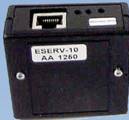
Konwerter obsługuje szeroki zbiór protokołów ethernetowych, wśród których znajdują się: BOOTP, TFTP, TCP, IP, UDP, ICMP, ARP oraz HTTP 1.1.
