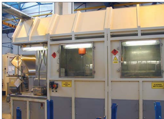
Linia do trawienia elementów po szlifowaniu - widoczny kosz na stanowisku załadunkowym, wanny z roztworami trawiącymi niewidoczne za szklanymi instalacji.
