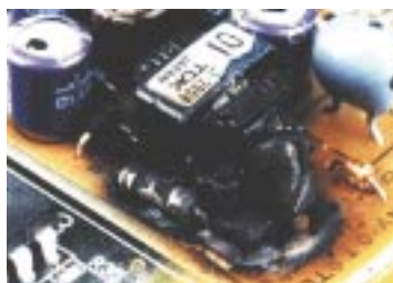
Rys. 3 Przykłady uszkodzeń wywołanych przez przepięcia dochodzące od strony zasilania oraz od strony portów sygnałowych
