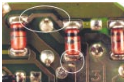
Rys. 2 Drobne uszkodzenia wywołane przez przepięcia
