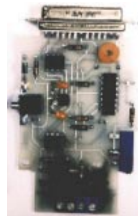
Rys. 3 Przykłady uszkodzeń wywołanych przez przepięcia dochodzące od strony zasilania oraz od strony portów sygnałowych
