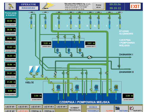
Ekran główny – schemat technologiczny ujęć wody i ZUW z podstawowymi parametrami oraz sygnalizacją pracy pomp
