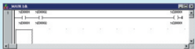
Rys. 5. Program w języku drabinkowym po konwersji z listy instrukcji
