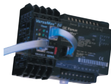
VersaMax Nano wraz z podłączonym konwerterem RS232/485 na Ethernet
