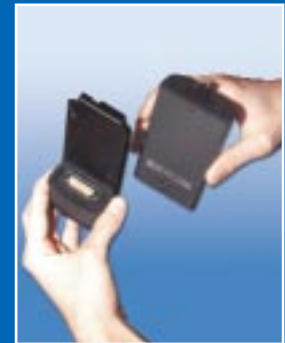
do zasilania radiomodemu można również użyć akumulatora...
