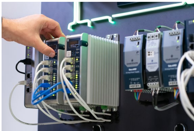
🔍 Kontrolery PACSystems od Emerson wykorzystywane do aplikacji przetwarzania brzegowego
